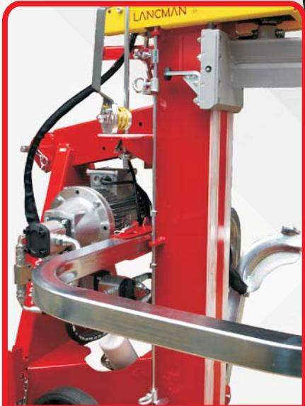
**Комбинированный привод дровокола: вал отбора мощности + эл.двигатель**
